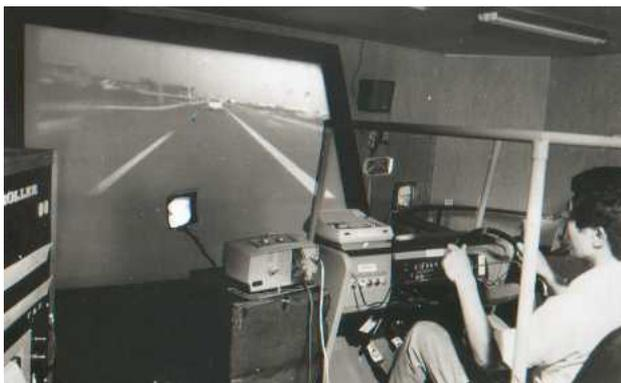
映像を使って反射行動を形成する訓練システム、特に眼を徹底的に鍛えるプログラムは、コンピューター技術が格段に進んだ今こそ生きるのではないかと思う。シミュレータ運転席の前面にはアクセル・ブレーキと連動する道路の映像、ミラーにも後続車や追い越す車の映像(16ミリや8ミリフィルム)が映し出されるようになっている。写真の運転席に座っているのは、映像制作のために映画会社から参加した私。
